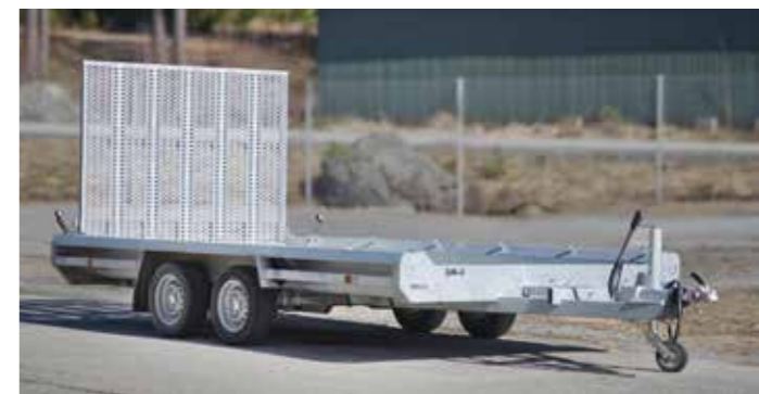
KULJETUSLAVETTI Hulco Terrax -2, jarrullinen, 2-akselinen koneenkuljetuslavetti Ajourampi vaunun kuormatilan levyinen (180 cm), lavan koko 180 x 394 cm, laitakorkeus 27 cm, kokonaisuudessa 3500 kg, kantavuus 2595 kg
