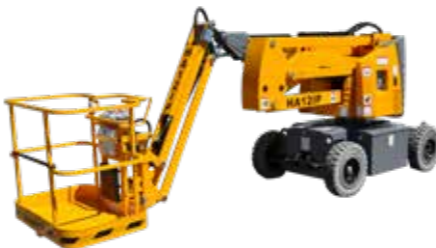
KUUKULKIJA Haulotte 12 IP kuukulkija, lavakorkeus 10 m, sivu-ulottuma 5/5m, omapaino 5900 kg
