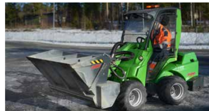
PIENKUORMAAJA Avant 630, runko-ohjattu pienkuormaaja puutarha- ja rakennustöihin Lisävarusteita mm: Kauhat; maakauha 245 l, hiekoituskauha 350 l, kauharja, trukkipiikit, ruohonleikkuri, lumiaura ja hiekoitin, maakaira. Kuljetettavissa kuljetuslavetilla!
