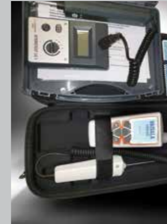
RAKENTEIDEN KOSTEUSMITTAUKSET Vaisala HUMICAP HM 40 ja GANH Hydrotest LG 1 kosteusmittareilla
